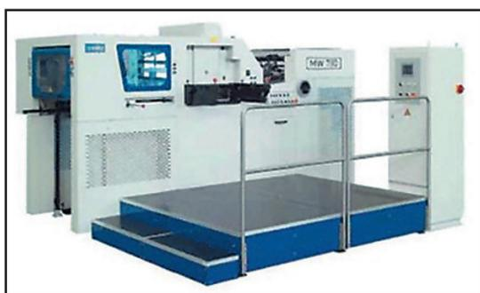
удаления облоя, стандартно входящая в состав машины, значительно сокращает время дальнейшей обработки продукции, увеличивая экономическую эффективность. Формат машины MW790 — 790x560 мм оптимально подходит для работы в паре с печатными машинами A2. MW790 имеет единственное отличие от модели MW790A — отсутствует секция удаления облоя.
